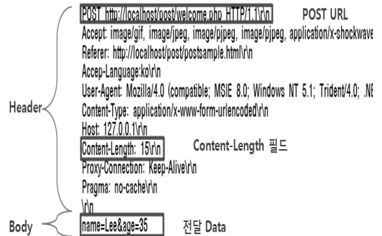
(그림 4) HTTP POST 요청 Header, Body
