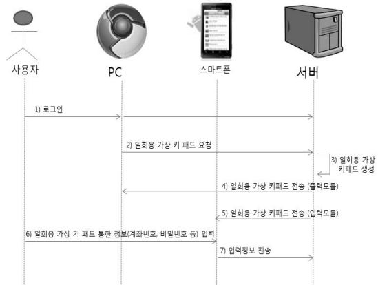
(그림 4) 멀티채널을 이용한 가상 키패드 구성
