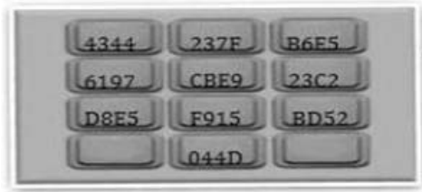
[그림 6] 일회용 가상 키패드 입력모듈 (스마트폰 화면. 자판별 4자리 숫자는 사용자에게 보이지 않음)
