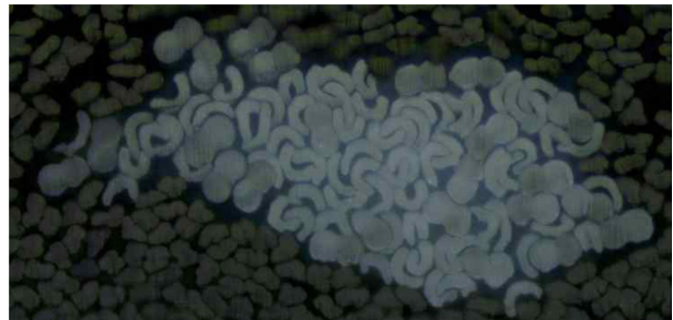
Figure 5. 리사이클 폴리에스터 다기능성 cotton-like 185De 단면.
