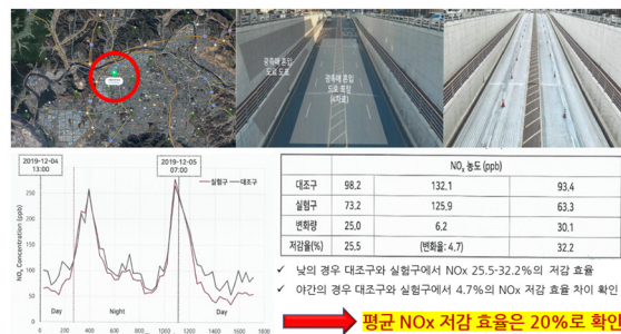
Figure 11. 한국건설기술연구원의 광촉매 실증 실험(한국건설기술연구원, 2020).
