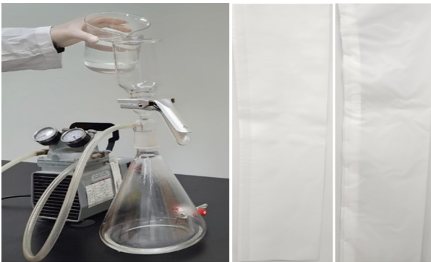
Figure 16. 진공여과, 필터링 장치(좌), nylon filter bag-10 mm(중,우). (출처 : KATRI시험연구원 미세플라스틱분석법(건조기))
