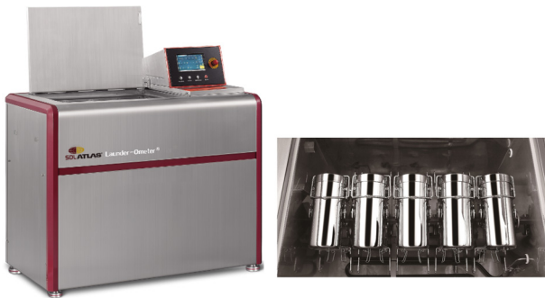
Figure 9. ISO 4484-1 표준에 따른 가속 세탁 장치(Launder-Ometer®). (출처 : SDLATLAS 공식 홈페이지)
