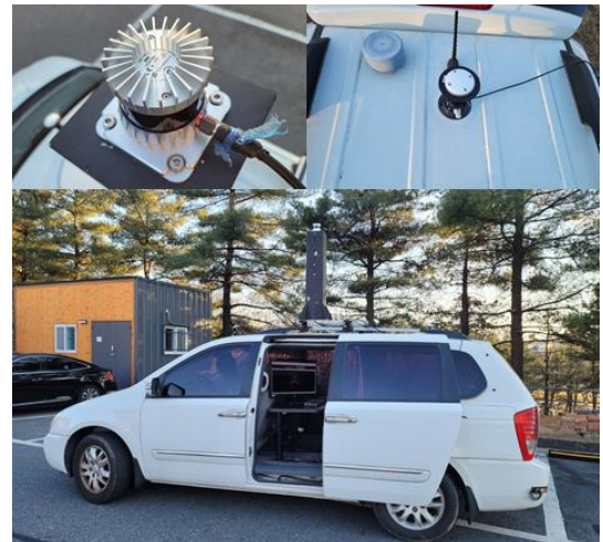
그림 2. 장치 및 센서(GPS 안테나)를 설치한 차량
