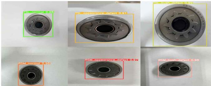
그림 2. 스타트 모터의 Normal, Appearance Defect, Bush Defect 검출 결과
