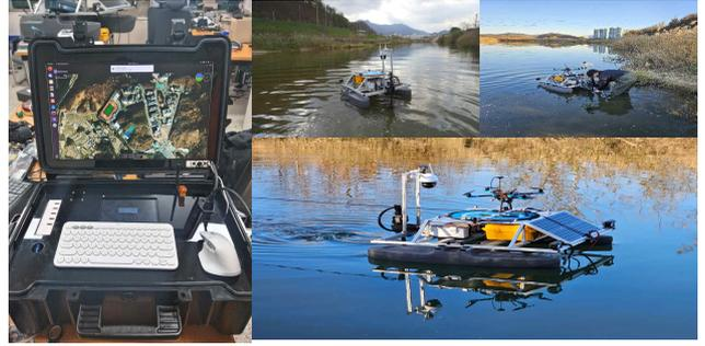
그림 5 무인 수상정 (좌 :GCS 시스템) (우 :개방수역 테스트)
