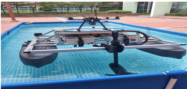
그림 4 무인 수상정 제한수역 테스트
