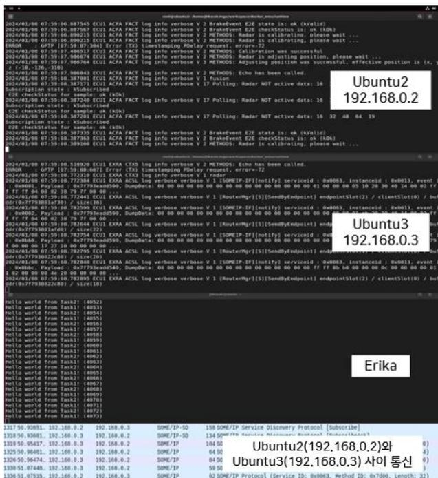
그림 3. Implementation of Simulation Architecture
